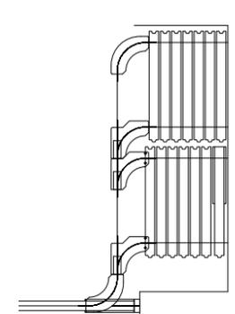
**Schräg oder gerade:** Parkbereiche mit Schrägstellung der Elemente sind über alle Höhen möglich, gerade Parallelstellung bis 7,5 m.
