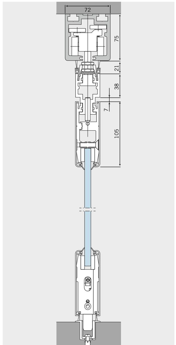
Comfort Element Straightline mit Tragprofil bei Ausführungen mit verfahrbarer Tür
